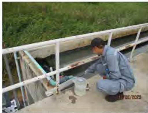
ภาพที่ 3-2 แสดงภาพการเก็บตัวอย่างน้ำทิ้ง บริเวณบ่อปรับสภาพน้ำ
